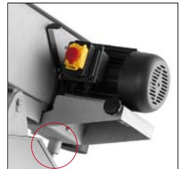
Un muelle en el soporte del motor crea automáticamente presión sobre la banda abrasiva.
