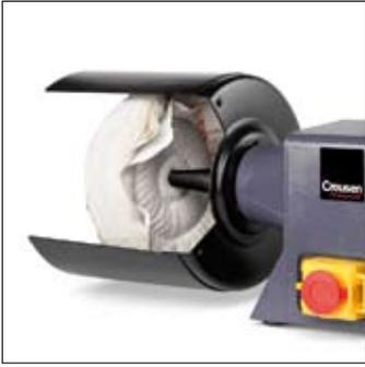
Las pulidoras dobles (DPC) se facilitan en dos versiones, para muelas pulidoras de 150 mm y 200 mm de diámetro, con diversas potencias nominales. Ambas versiones están dotadas de un husillo cónico a ambos lados e incorporan cubiertas de pulido a fin de optimizar las medidas de seguridad.
