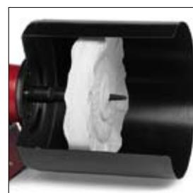
Las cubiertas para pulir garantizan la seguridad durante la labor de pulido.
