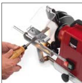
**Accesorio de afilado para afilar buriles de madera y muchos otros tipos para trabajar el metal**
