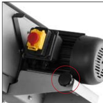
Control manual de la banda con ajuste de precisión
