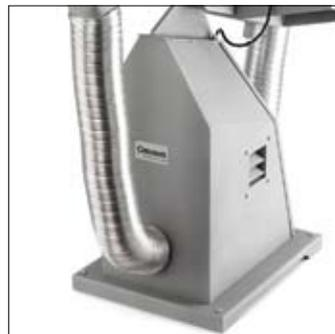
Doble extracción con tubos de extracción de aluminio
