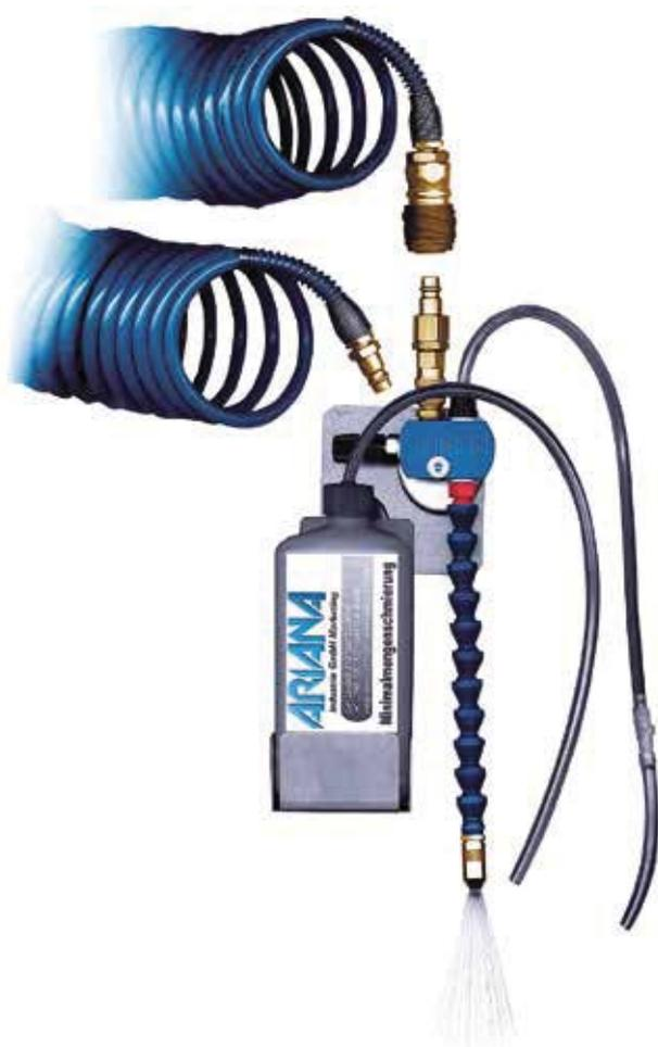
El [micro-sistema de ARIANA](#) está basado en una cabeza pulverizadora coaxial que genera un chorro circular con un ángulo de atomización. Girando la caperuza pueden generarse diferentes conos de pulverización para múltiples aplicaciones. La cabeza pulverizadora coaxial tiene un accionamiento neumático y el medio es alimentado a través de un recipiente separado sin presión.
