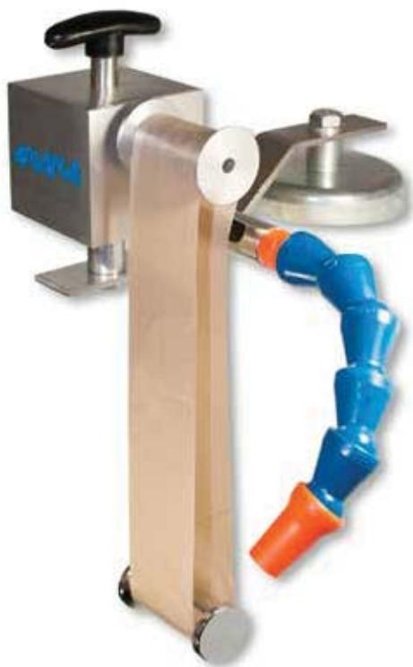
La cinta colectora de aceite es sujeta sobre el recipiente para líquidos por medio de un disco magnético, preferiblemente sobre la entrada del líquido en la parte opuesta. La placa básica de la unidad motriz tiene que ser colocada a unos 300 mm sobre el nivel máximo del líquido. En los soportes de salida se coloca la manguera que lleva a un tanque.
