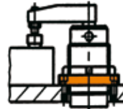
Con brida roscada y tuerca ranurada
