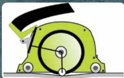
Esquema del control automático de la profundidad
