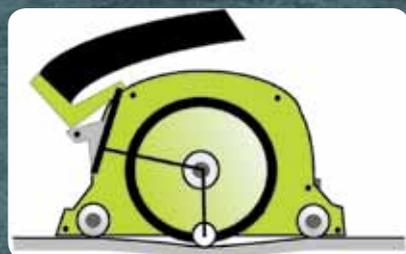
Esquema del control automático de la profundidad
